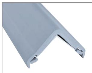
L'ANGL'ISOL® plat assure la protection des personnes et du matériel dans les lieux exigus où un encombrement minimum est nécessaire. Avec une épaisseur inférieure à 8 mm, il n'empiète pas sur les aires de circulation. Le profil en élastomère est clipsé sur le rail aluminium préalablement vissé sur tous supports : plaque de plâtre, béton, brique, carrelage, bois.
