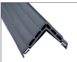
L'ANGL'ISOL® à alvéoles plates avec une épaisseur réduite s'intégrera parfaitement à toutes les décorations. Tout en préservant les personnes contre un impact sur une arête vive, son dessin en fait le complément idéal des plinthes et lisses murales. Le profil en élastomère est clipsé sur le rail aluminium préalablement vissé sur tous supports : plaque de plâtre, béton, brique, carrelage, bois. Cette technique garantit une fixation efficace et totalement invisible.
