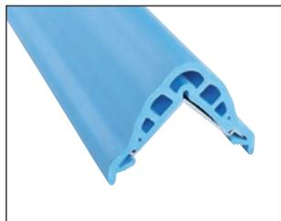
L'ANGL'ISOL® haute Protection se caractérise par sa **structure à alvéoles** qui lui confère une **haute capacité d'absorption d'impact** et la **protection des personnes** dans leur environnement. Le profil en élastomère est **clipsé sur le rail aluminium** préalablement vissé sur tous supports : plaque de plâtre, béton, carrelage, bois.
