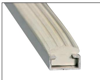
La lisse murale à plat se caractérise par un encombrement réduit, une fixation invisible et une interchangeabilité aisée du profilé de protection souple. Elle est destinée à la protection contre les chocs de tout type de surface plane en linéaire. Elle est fixée sur un rail.
